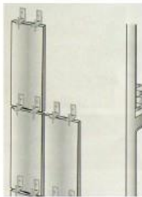
3 تثبيت اللوح علي الأرض وتثبيتته بالقمطة المعدنية أو الخشبية
