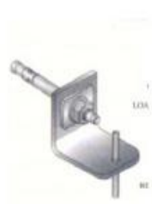
4 تثبيت الألواح فوق بعضها عن طريق البن المعدني
