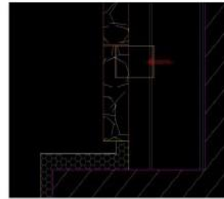
4 تفصيلية توضح التفاء اخر بلاطة رخام مع البلاطة الخرسانية
